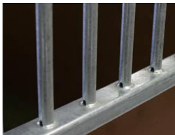
Robotsvetsade runda gallerrör.
